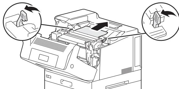
3. 内部に破れた紙片が残っていないかを確認し、レバーを戻します。
