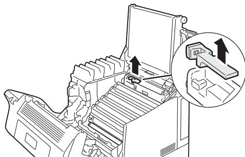
8. ドラムカートリッジがセットされていた溝に清掃用パッドを差し込み、左右どちらか一方向から1回だけガラス面（光路（レーザー）部）の汚れを取り除きます。
