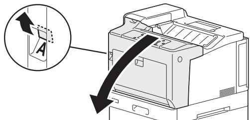
2. 図の位置にあるレバーを押し下げ、詰まった用紙がある場合は取り除き、内部に破れた紙片が残っていないかを確認し、レバーを戻します。
