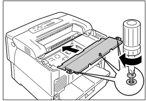
10. 後部カバーを戻し、ネジで2か所をドライバーで固定します。
