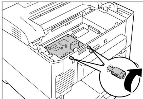
9. 金属板カバーを戻し、ネジで3か所をドライバーで固定します。
