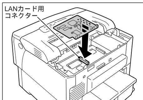
7. 図の部分を上から押して、LAN カードを確実に差し込みます。
