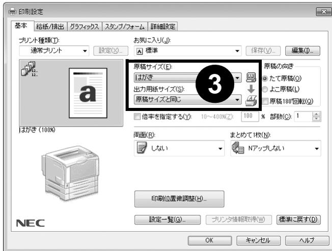
③ [基本] タブで、[原稿サイズ]、および [出力用紙サイズ] に印刷に使用するはがきや封筒サイズを設定します。定形サイズの封筒やはがきを使用する場合は、⑥に進みます。
