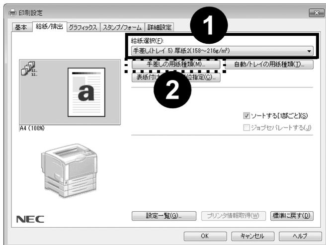
① **〔給紙 / 排出〕** タブで、**〔給紙選択〕** から **〔手差し (トレイ 5) 厚紙 2 (158~216g/m<sup>2</sup>)〕** を選択します。
