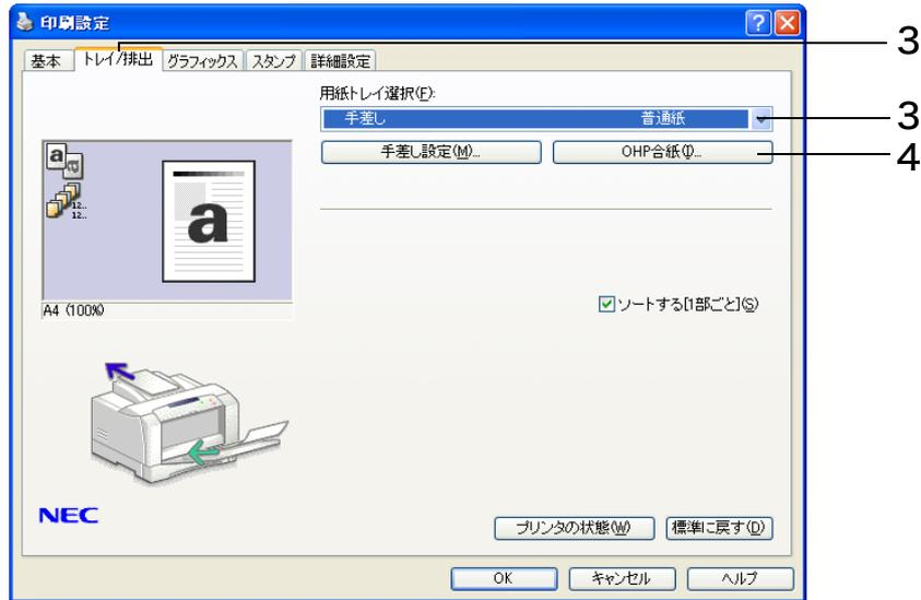
5. [手差し用紙種類] から [OHP フィルム] を選択し、[OK] をクリックします。必要に応じて、[OHP 合紙をする] チェックボックスを選択し、排出される OHP フィルムに白紙を挿入します。
