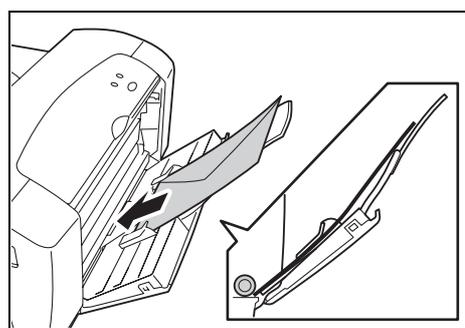
3. 用紙ガイドを、セットした封筒のサイズに合わせます。
