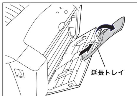
2. 印刷する面を下にして、図のように、用紙を完全に挿入します。
