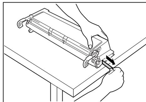
6. EP カートリッジの取っ手を持ち、EP カートリッジの両側の突起部を、プリンターの内部の溝に沿わせて、図に示すように溝にスライドさせてセットします。
