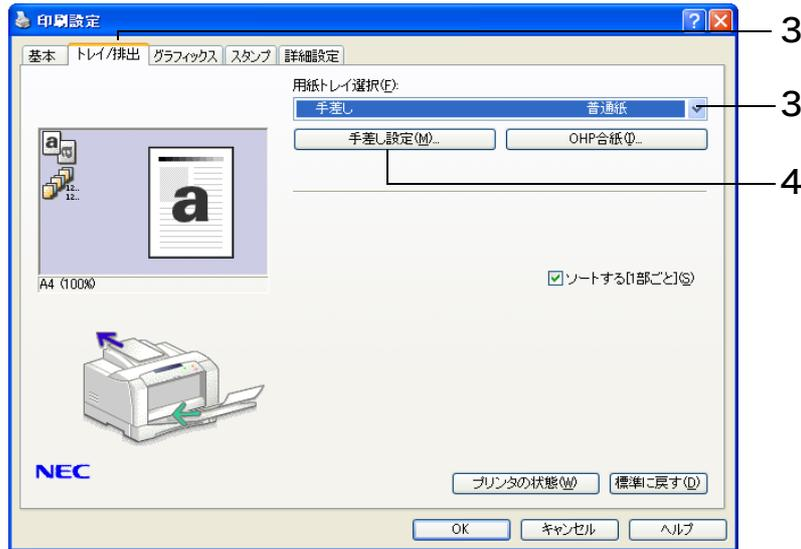
5. [手差し設定] ダイアログボックスの [手差し用紙種類] リストボックスから [厚紙 (82 ~ 128g/m<sup>2</sup>)] を選択し、[OK] をクリックします。
