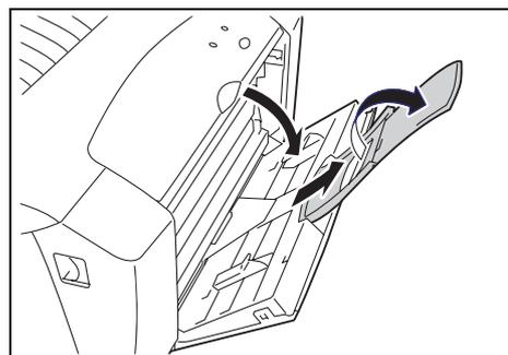
2. 印刷する面（例：白紙面）を下にし、たて置きにセットします。
