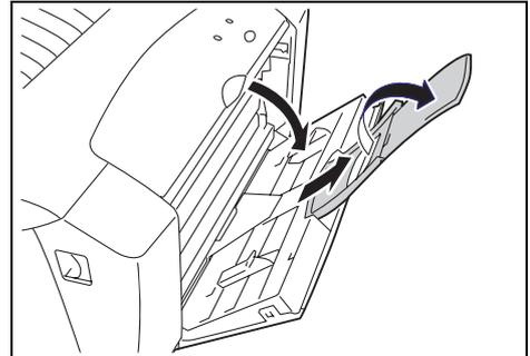
2. 封筒をたて置きで、フラップを上側にしてセットし、図に示すように完全に挿入します。
