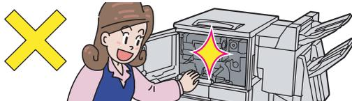
このプリンターはレーザー（レーザーダイオード）を使用しています。電源がONになっているときに内部をのぞいたり、鏡などを差し込んだりしないでください。万一、レーザー光が目に入ると失明するおそれがあります（レーザー光は目に見えません）。
