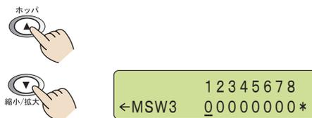
8 [▶]スイッチを7回押して、カーソルをMSW3-8に移動する。
