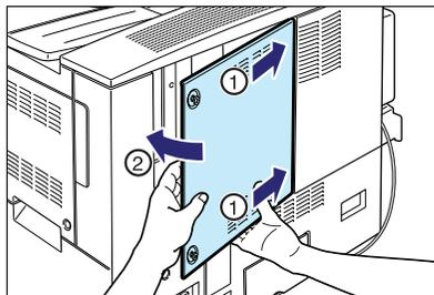
8 手順2でゆるめたネジを締めて、プリンターオプション用カバーを固定する。
