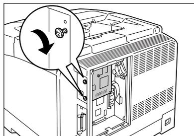
7. 背面カバーを戻し、ネジで 2 か所を固定します。
