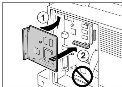
5. 図の部分を上から押して、LAN カードを確実に差し込みます。
