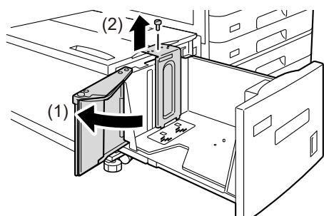
2) ガイドの下部にある突起を、用紙サイズの穴に差し込み（1）、ガイドの上面にある用紙サイズの穴に、用紙トレイの突起を差し込んで、ネジを締めます（2）。
