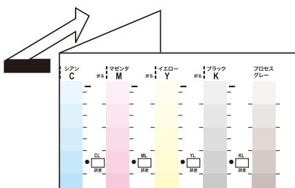
2. 階調補正チャートの補正する濃度を、階調補正用色見本の同じ濃度の場所に合わせます。
