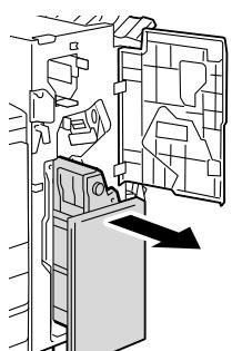
**3.** 中とじ用ホチキスカートリッジのレバーを持ち、下方向に倒してから、上に引いて取り出します。
