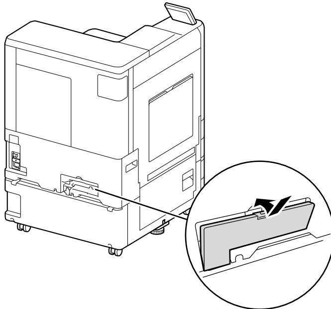
**17.** 転倒防止ストッパーの高さを調節します。
