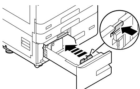
**4. プリントする面を上にして、用紙の先端を左側にそろえてセットします。**
