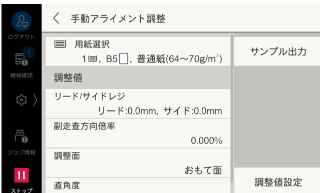
**7. 【調整面】で調整する印刷面を選びます。**
