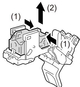
**6.** 新しいホチキス針ケースを挿入し(1)、後方を押してセットします(2)。
