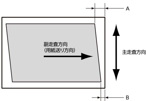
用紙の先端を上にしたときに、左側のリードレジの長さ（mm）を「A」、右側のリードレジの長さ（mm）を「B」として、次の式で直角度のずれ量を求めます。
