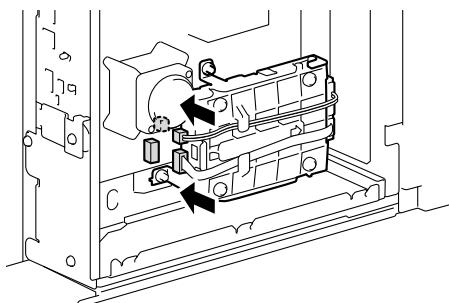
**8. 背面カバーを戻し、ネジで 2 か所を固定します。**
