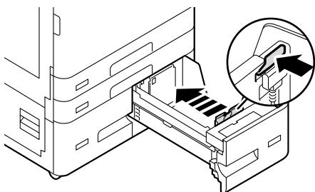
**4. プリントする面を上にして、用紙の先端を左側にそろえてセットします。**
