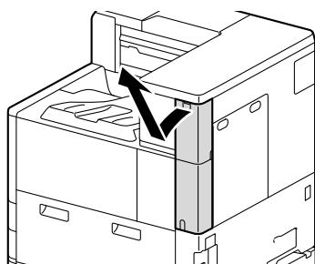
**4.** ネジを外し、イーサネットコネクターカバーを取り外します。
