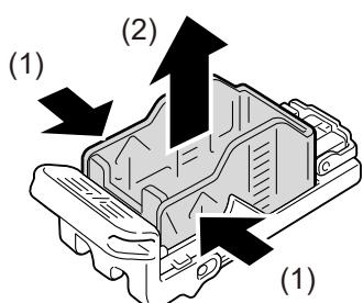
**4.** ホチキスカートリッジに新しい針ケースを挿入し (1)、後方を押してセットします (2)。
