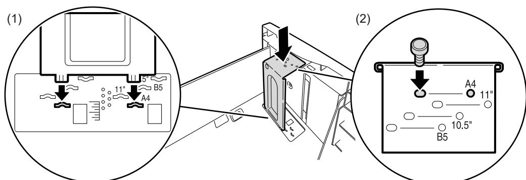
5) 図のようにエンドガイドのレバーを引き上げ（1）、レバーを溝に沿って移動させながら用紙サイズに合わせて（2）、レバーを下ろします（3）。
