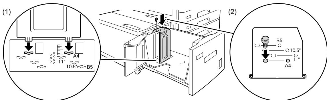
3) 手前のガイドのネジを外し、ガイドを用紙トレイから外します。
