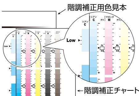
3. 階調補正チャートの・印を起点に階調補正チャートを上下にずらして、階調補正用色見本との誤差を目盛りから読み取ります。
