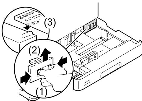
**4.** プリントする面を上にして、用紙の先端を左側にそろえてセットします。
