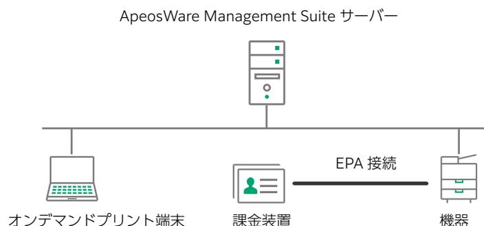
課金装置を機器とだけ接続して、オンデマンドプリント端末とは接続しない構成です。
